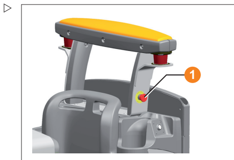
1 Přídavné spínače nouzového vypínání (levá a pravá strana vozíku)
